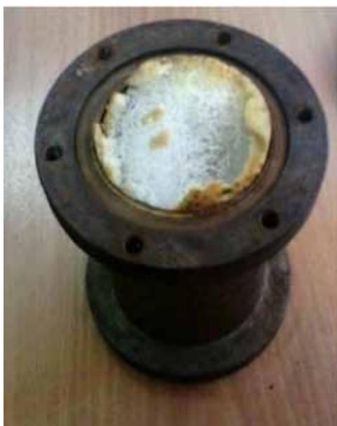
Рис. 3. Синтезированные гидраты природного газа Средневилюйского ГКМ и их горение
