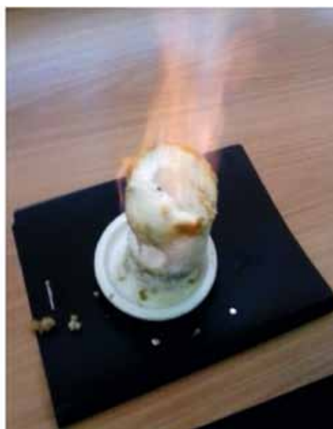
Рис. 3. Синтезированные гидраты природного газа Средневилюйского ГКМ и их горение
